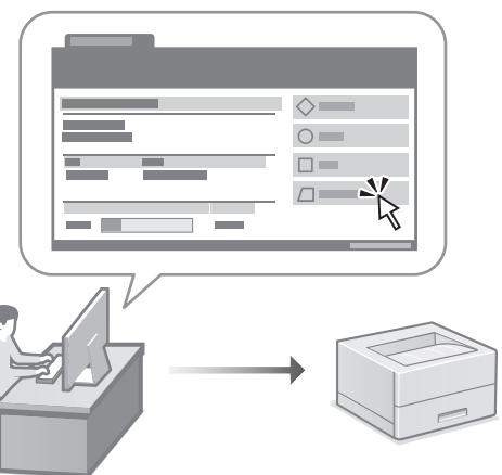
Uzak Kullanıcı Arabirimı bu makinenin bilgisayarda bir Web tarayıcıyla yönetilmesini sağlar. Bu arabirim makinenin çalışma durumunu incelemek ve ayarları değiştirmek için kullanabilirsiniz.
