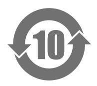
本标识根据「电器电子产品有害物质限制使用管理办法」,适用于在中华人民共和国销售的电器电子产品。标识中央的数字为环保使用期限的年数。只要您遵守该产品相关的安全及使用注意事项,在自制造日起算的年限内,不会产生对环境污染或人体及财产的影响。上述标识粘贴在机器背面。下表是依据 SJ/T 11364-2014 的规定编制。
